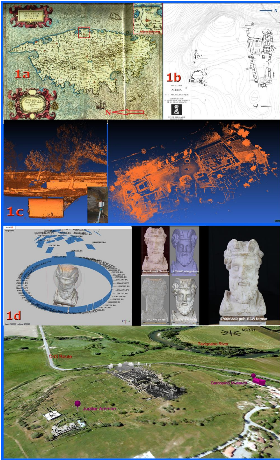
Fig. 1a - G. A. Magini 1620, Aleria ad Est; 1b-Planimetria del sito: il foro a nord, l'anfiteatro e i bastioni a sud; 1c-rilievo laser scanner 3D: il foro e la cisterna; 1d-modello 3D da dense stereo matching di foto,
