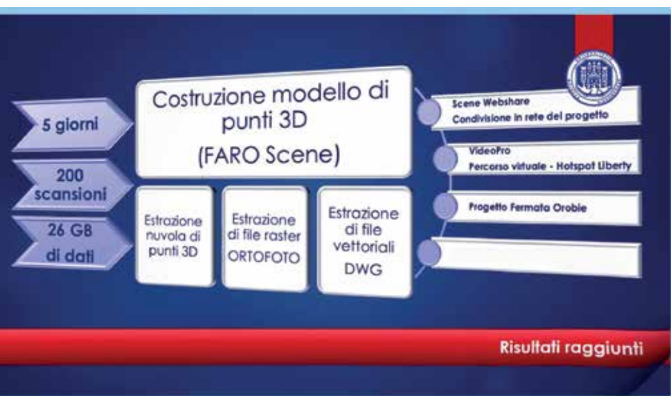
Fig. 5 - Sequenze operative del processo di rilevamento.
