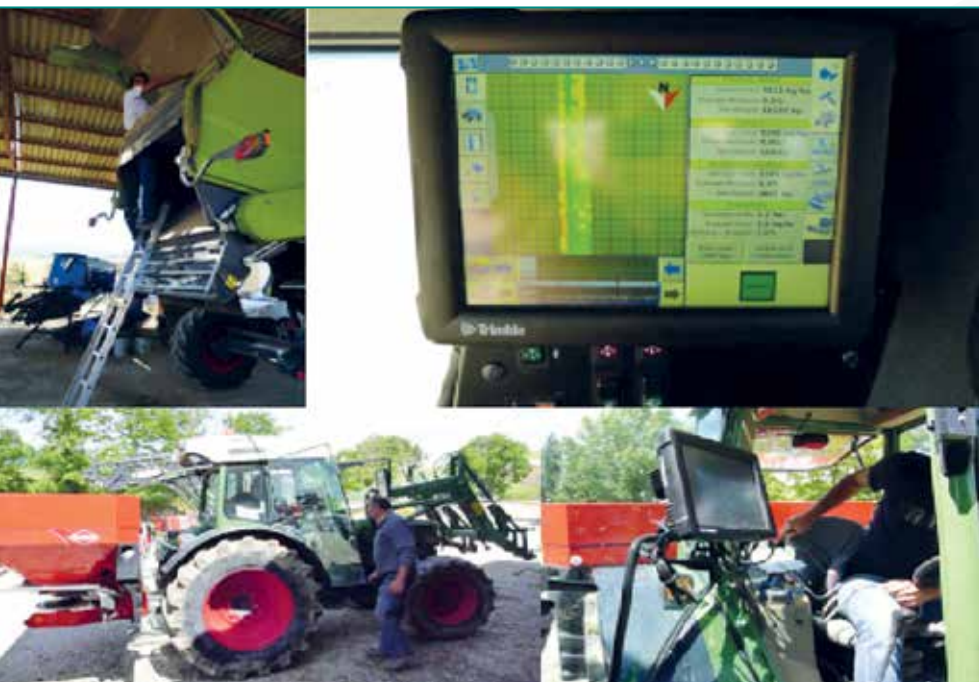
Fig 1 - Installazione della strumentazione per georeferenziazione e sistemi di controllo e misura su metitrebbiatrici e trattori.
