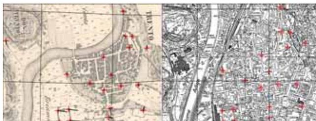
Figura 2 - Analisi della Carta Topografica Fersinale (1850) rispetto alla CTP: dettaglio dell'area urbana di Trento. A sinistra: griglia di distorsione e vettori di disallineamento.
