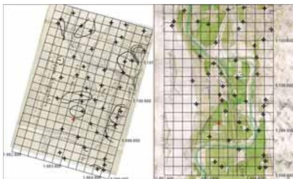
Figura 5 - Analisi dei due cabrei idraulici del 1777 di G.B. Scotini. Griglia di distorsione, vettori di disallineamento e isolinee del fattore di scala locale.
