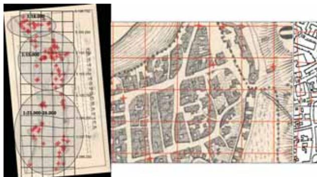
**Figura 1 - Analisi della Carta Topografica Fersinale (1850). A sinistra: griglia di distorsione, variazione di scala locale e vettori di disallineamento; a destra e al centro: analisi della *new map* rispetto alla *old map* (comparazione inversa).**
