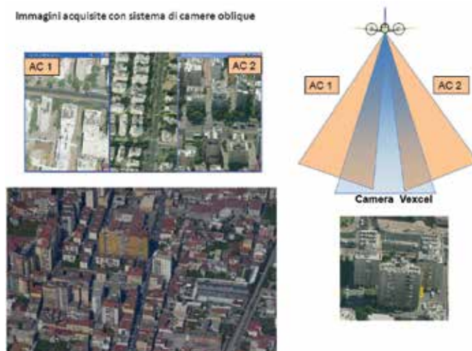
Fig. 5 - Sensori obliqui integrati nel processo di presa fotogrammetrica.
