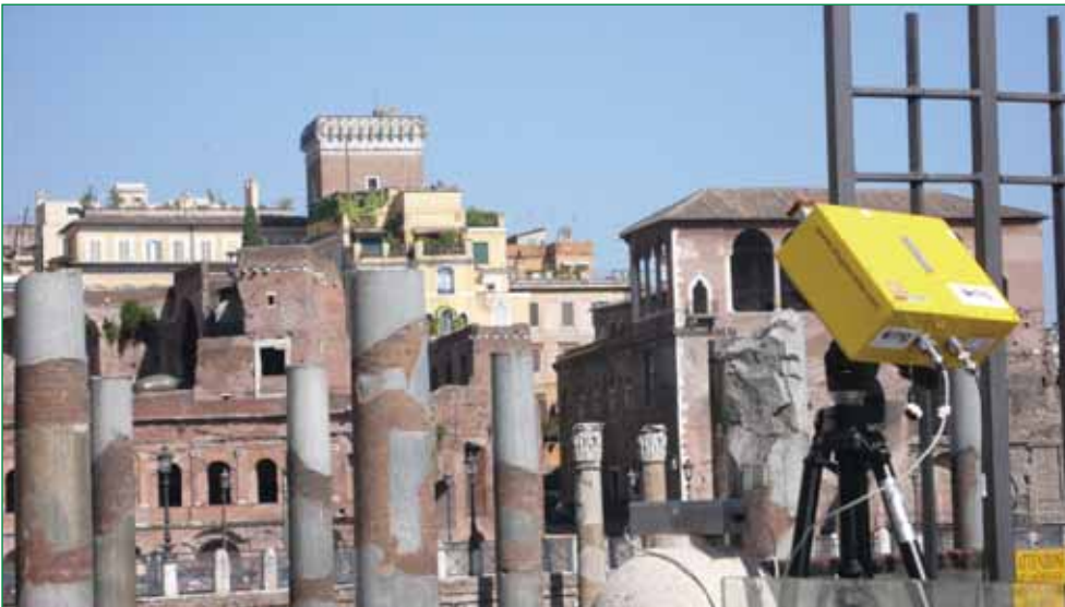
Monitoraggio strutturale con Interferometria Terrestre nella città di Roma.
