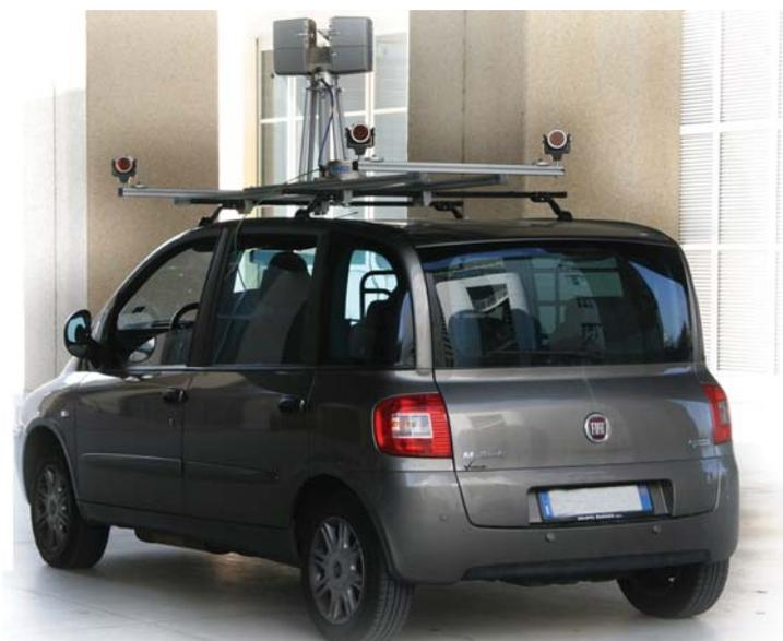
Figura 1 - Piattaforma montata sul tetto del mezzo mobile
