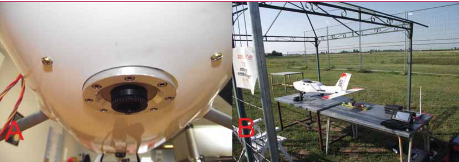
Figura 2 - (A) Camera termica in posizione nadir a bordo del velivolo MDV Cardinal (B) Velivolo Cardinal e stazione di controllo a terra.
