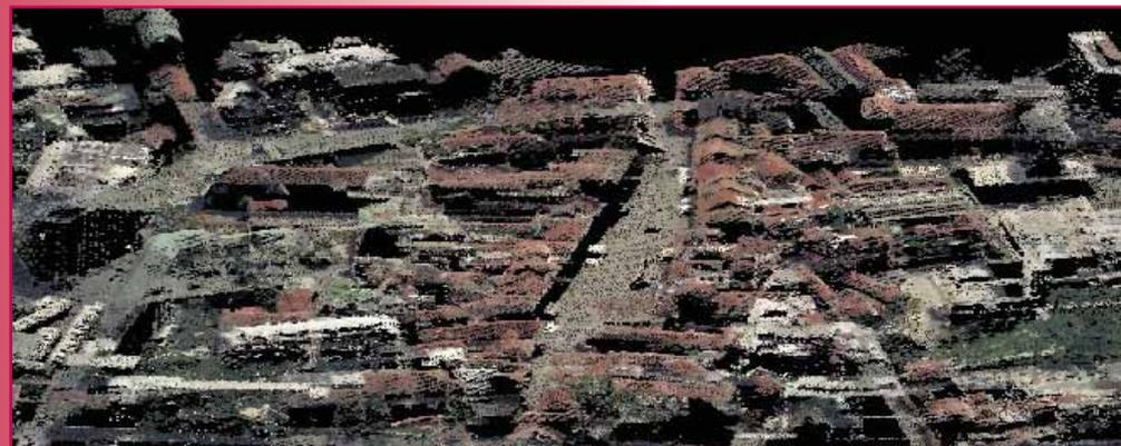
Figura 10 - Vista prospettica di Laser Scanning colorato con ortofoto
