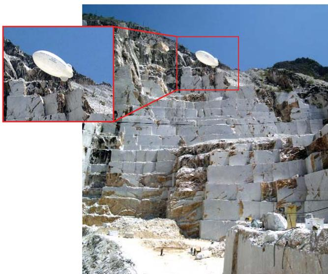
Fig.2 - Fotogrammetria digitale in una cava con palloni aerostatici
