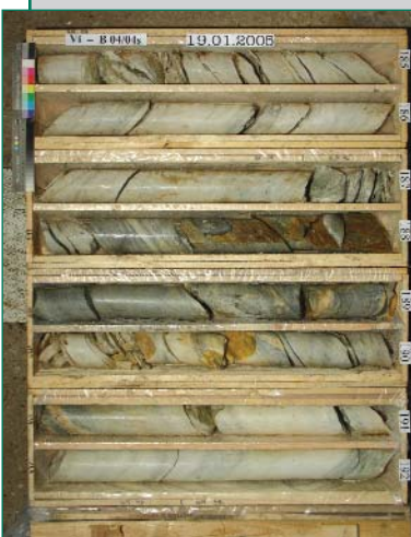
Figura 8 - Esempio di carote estratte da un sondaggio (fonte: BBT SE)
