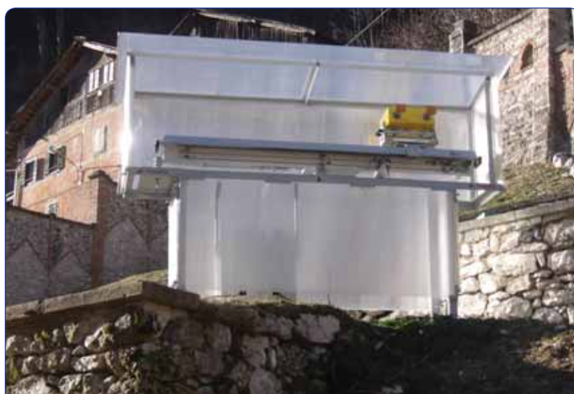
Figura 1 - Esempio di interferometro SAR terrestre modello IBIS-L installato su piattaforma QUIB™.
