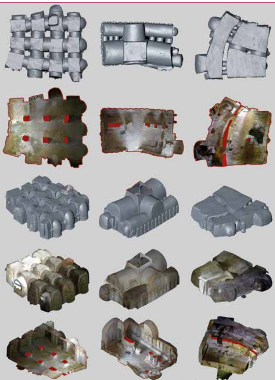
Fig. 1 - Rilievo fotogrammetrico 3D delle chiese rupestri dei Santi Stefani a Vaste (colonna a sinistra), della Lama d'Antico (colonna al centro) e di San Lorenzo a Fasano (colonna a destra).
