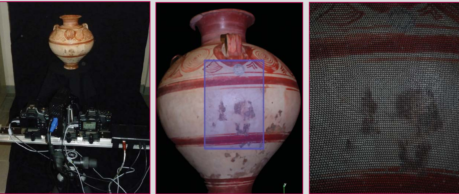
Figura 3 - Zscan ST di menci software, modello 3D del vaso, dettaglio in rappresentazione wireframe.
