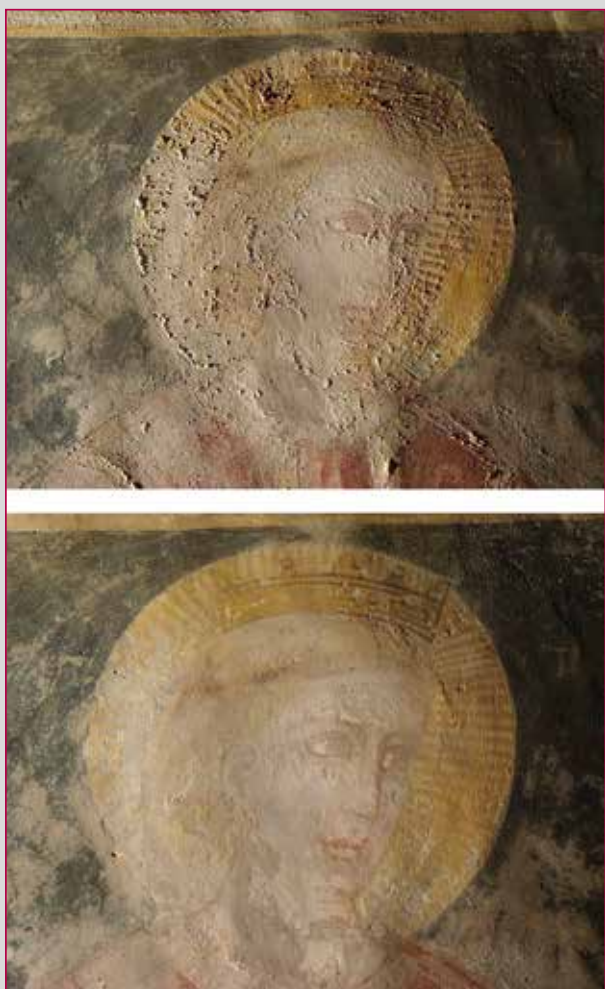
Fig. 1 - Particolare di un affresco del XIII secolo decorante le muraure della Cripta della Basilica di San Zeno a Verona: alto, prima del trattamento nanotecnologico (forte polverizzazione del film pittorico); basso, dopo l'applicazione di nanoparticelle di calce spenta, \text{Ca}(\text{OH})_2 , e successiva reazione con anidride carbonica atmosferica a formare una resistente "ragnatela" di cristalli di calcite, \text{CaCO}_3 , consolidante compatibile con la matrice dell'opera d'arte (CSGI).
