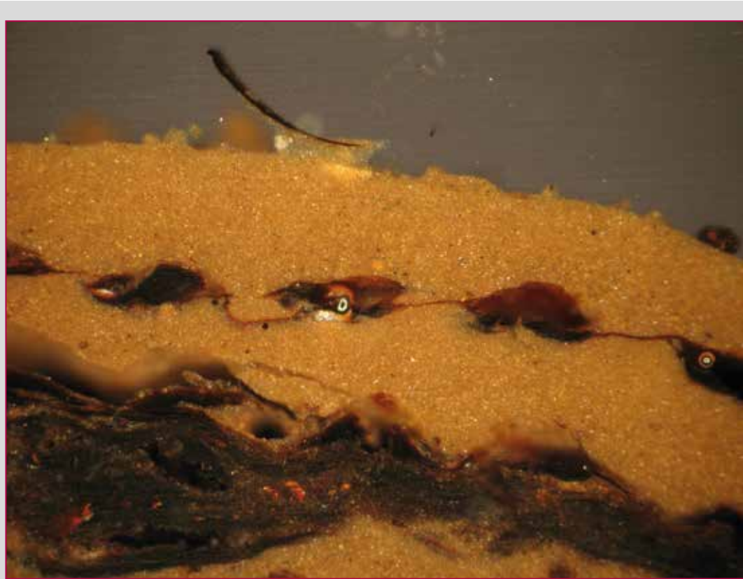
Fig. 3 - Cross section di un frammento prelevato dalla veste sepolcrale di Gian Gastone de' Medici. La foto mostra il deposito del fango penetrato all'interno della struttura del tessuto e diventato sia l'armatura portante che il principale fattore di degrado.
