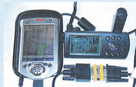
Dida: In figura viene mostrato il collegamento dei due cavi seriali realizzati tramite il Gender Charter e l'adattatore Null Modem.
