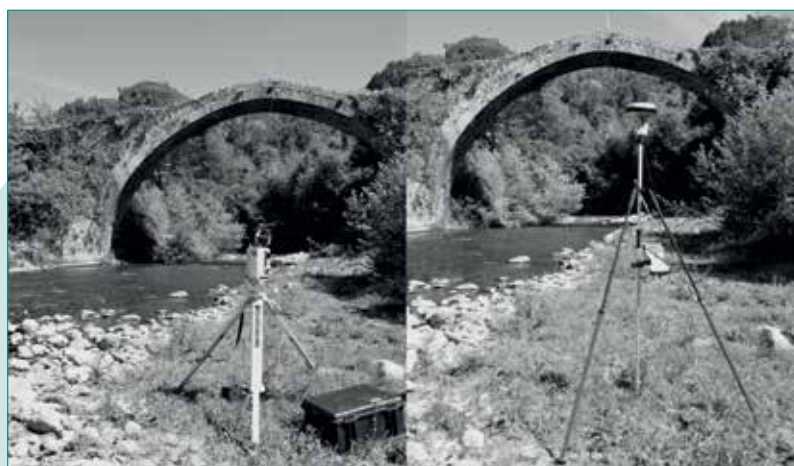
Fig. 2 Rilievo del Ponte di Annibale con Laser Scanner e ricevitore GNSS
