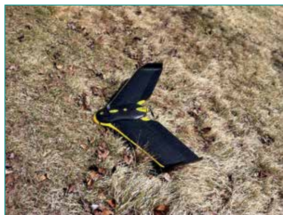
Fig. 3 - Il drone ad ala planante UAV (eBee SenseFly).
