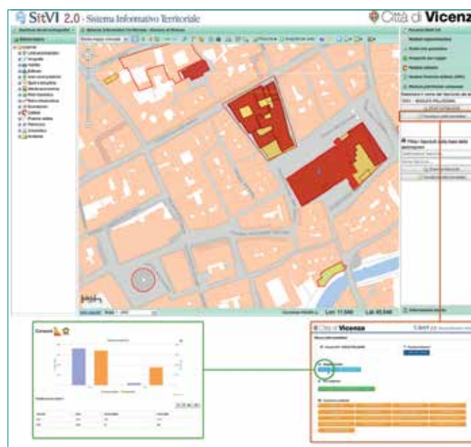
Fig. 3 – Interfaccia grafica di SITVI 2.0 con particolare del modulo di gestione del patrimonio comunale che consente una visualizzazione sempre aggiornata di concessioni in atto e circa l'andamento dei consumi (gas, elettricità, acqua, etc.)
