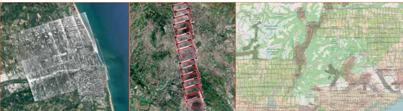
Fig. 2 - Risultati della georeferenziazione automatica di due blocchi di immagini e di alcuni ingombri delle strisciate, visualizzate all'interno del GIS dell'AFN.
