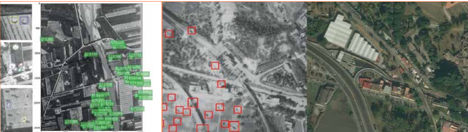
Fig. 4 - Risultati dell'identificazione supervisionata ( machine learning ) di crateri di bomba in immagini aeree (sinistra). Crateri di bomba identificati in un'immagine storica a confronto con un'immagine attuale (destra).
