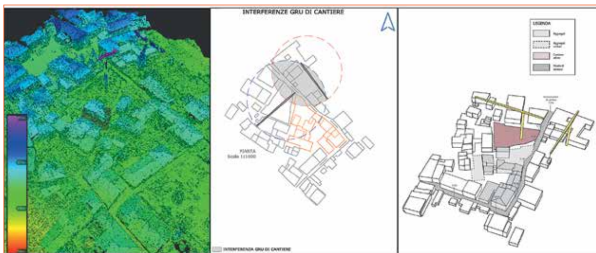
Fig. 6- a) Nuvola di punti con individuazione delle gru (elementi in viola e in blu); b) modello 3D semplificato, ricostruito dalle informazioni della nuvola di punti e individuazione delle interferenze gru nelle zone adiacenti il cantiere; c) Analisi interferenza gru nel centro storico di Villa S. Angelo (Aq). Immagini estrapolate dalla tesi laurea in Ingegneria Civile di Marcone Claudia "Fotogrammetria da UAV per una gestione "smart" del cantiere. Relatore: Prof.ssa Donatella Dominici, Prof. Pierluigi De Berardinis; Correlatore: Ing. Maria Alicandro.
