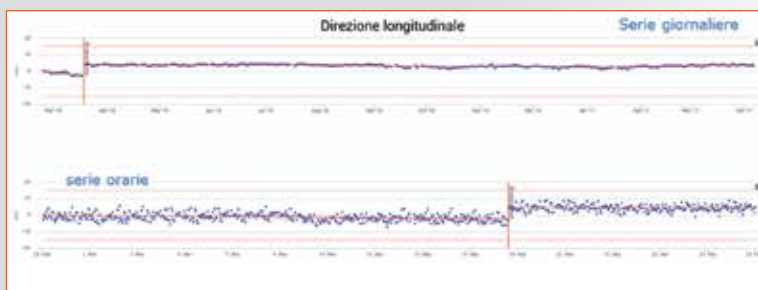
Fig. 8 - Monitoraggio orario di una base corta per un periodo di 7 mesi: si evidenzia una discontinuità in Est alla data 18 marzo 2016.
