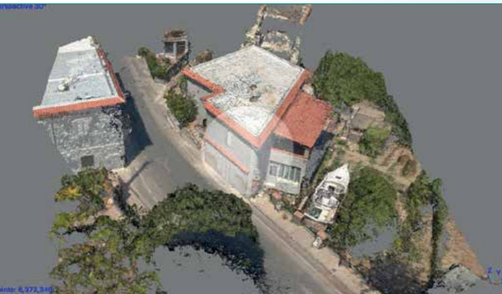
Fig.1- Modellazione 3D di un edificio con rilievo di immagini da drone
