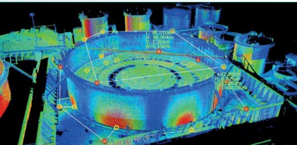
Una domanda crescente di sicurezza per gli operatori, insieme alla necessità di avere a disposizione modelli *as-built* degli impianti: queste le motivazioni principali che hanno determinato la scelta di Paresa S.p.A. nell'adottare un nuovo approccio per le operazioni di rilievo topografico per gli interventi sul costruito e la progettazione del nuovo.
