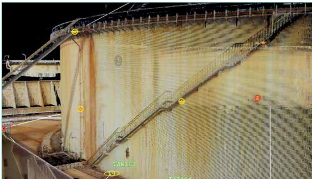
sta diventando uno strumento cardine della progettazione BIM; adottare una nuvola di punti georeferenziata e ben filtrata dal "rumore" generato dall'ambiente circostante, permette di estrapolare una serie di informazioni qualitative e quantitative del dato grezzo del rilievo. Elaborando il dato in modelli tridimensionali più
