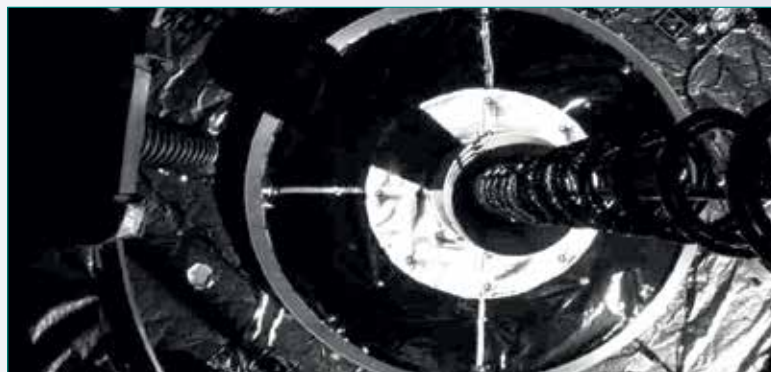
Fig. 6 - Il momento del "docking" fra MEV-1 ed Intelsat 901.
