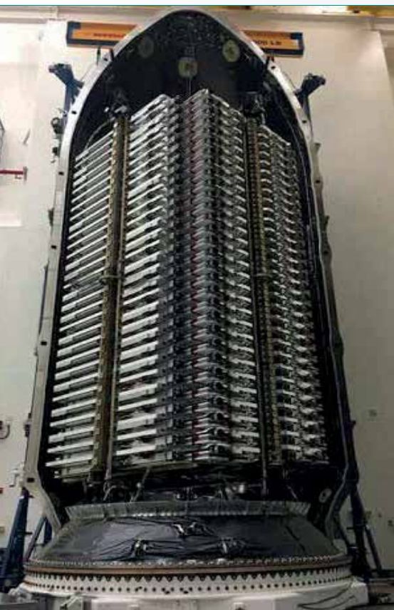
Fig. 5 - La "catasta" con 60 satelliti Starlink nello stadio finale del lanciatore Falcon 9.
