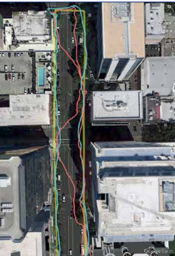
Fig. 6 - Effetto della modellizzazione 3D (la linea gialla è il percorso reale dell'utente; quella rossa la stima del ricevitore senza correzione delle riflessioni; quella celeste la traccia corretta attraverso i modelli 3D).
