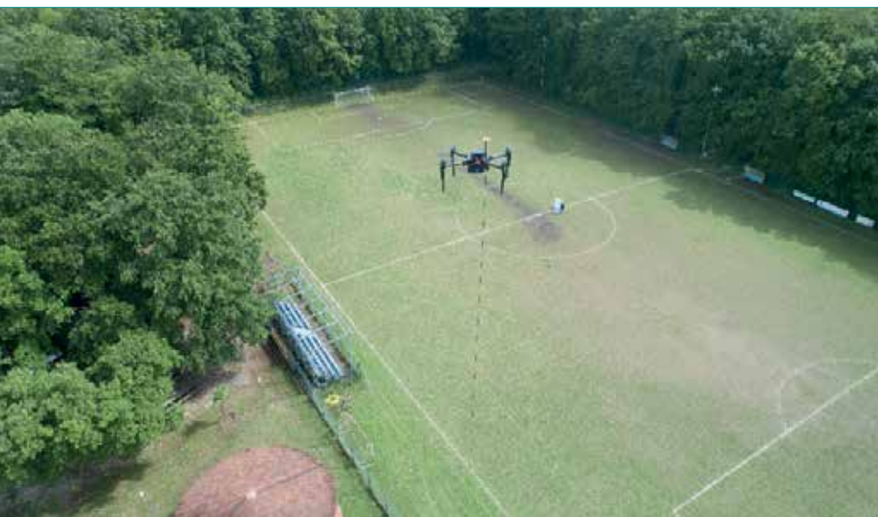
Fig. 5 - Drone “tethered” per le riprese aeree di eventi sportivi.
