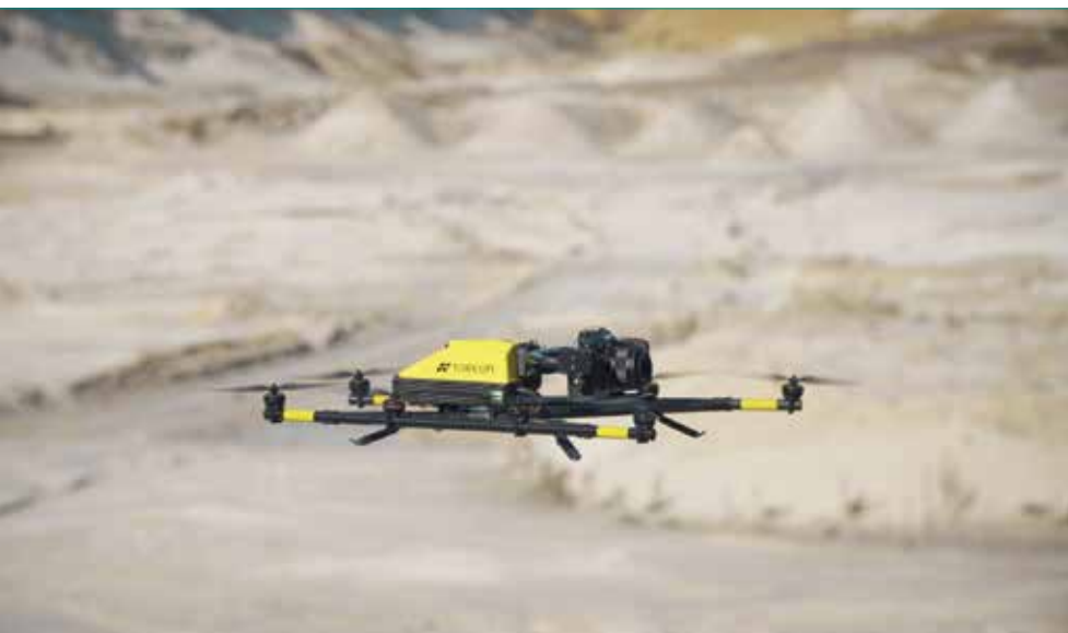
Fig. 3 - Il Falcon 8+ è dotato di sensori di prima classe, smorzamento attivo delle vibrazioni e camera mount stabilizzato automaticamente per prestazioni solide su qualsiasi terreno.
