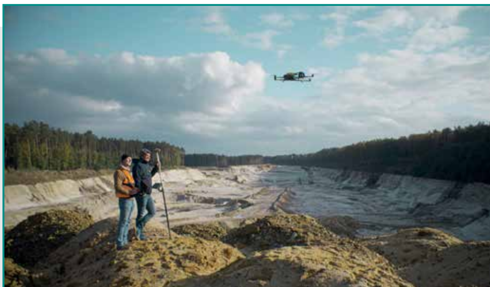
Fig. 2 - Utilizzando il drone Intel Falcon 8+ di Topcon per ispezionare le scorte nella cava, i cavatori sono ora in grado di raccogliere dati accurati ed efficienti in tempo reale.
