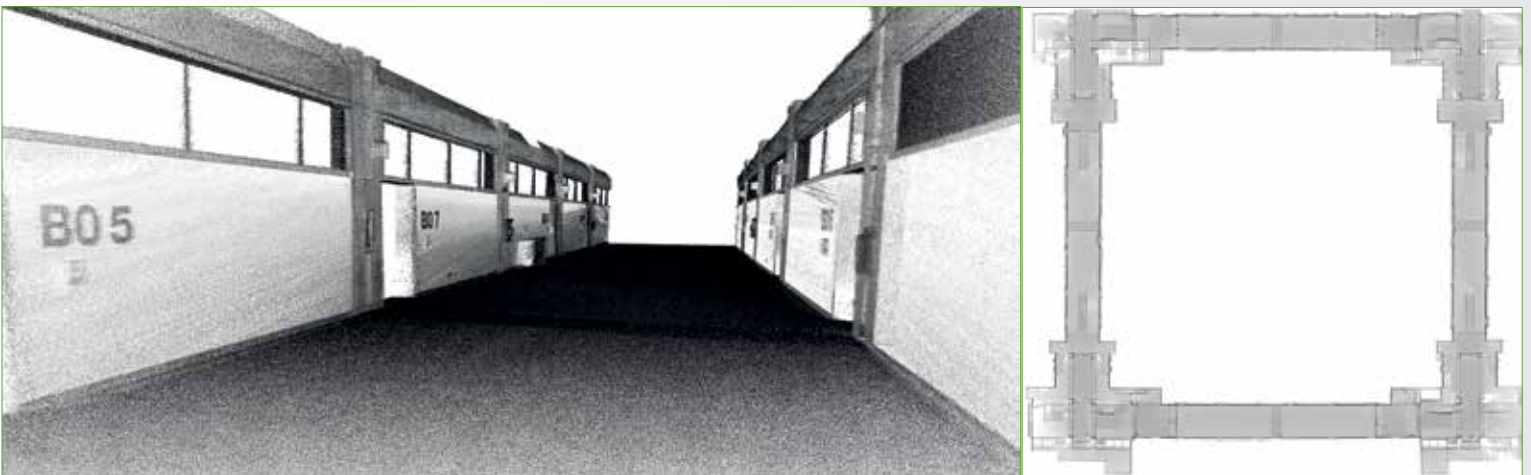
Fig. 2 - Nuvola di punti (in alto) e ortofoto (in basso) del piano terra dell'edificio dei Rizzi dell'Università degli Studi di Udine. I risultati sono stati ottenuti con strumento laser scanner portatile.
