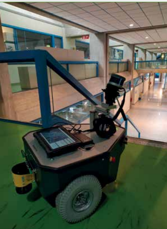
Fig. 4 - Sistema di mappatura portatile montato su piattaforma mobile. Tale configurazione è stata utilizzata per valutare i vantaggi della piattaforma mobile rispetto al rilievo eseguito manualmente da un operatore.
