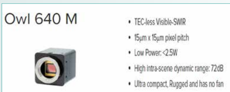
Fig. 1 -Sensore Owl con le sue principali caratteristiche.
