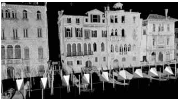
Nuvola di punti con indicazione della posizione dei punti di presa delle immagini.
