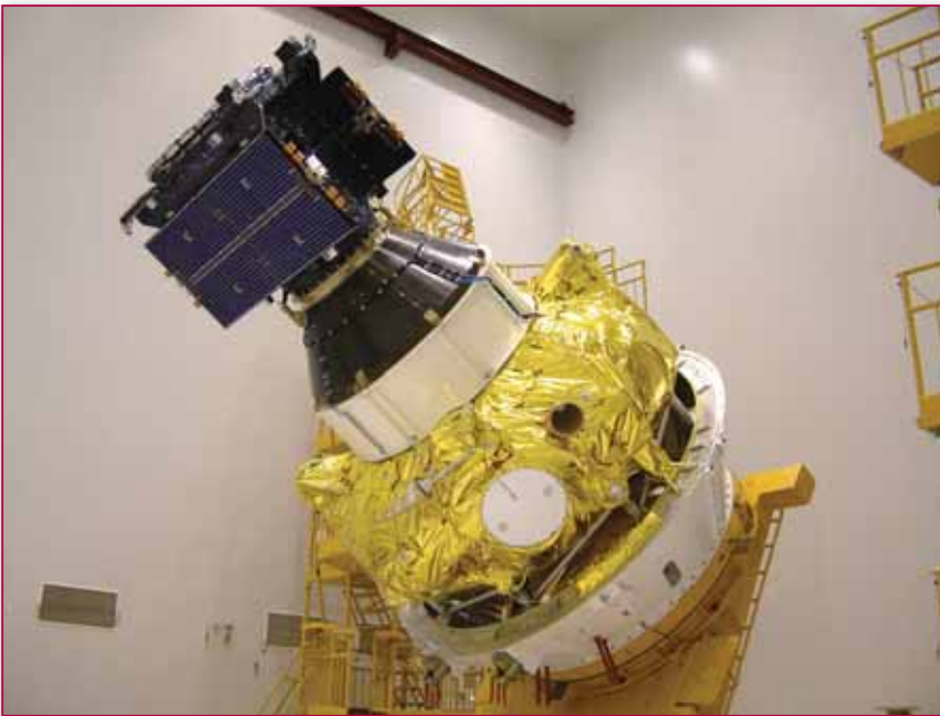
Il satellite Giove-A, ideato per validare l'orbita del futuro sistema di posizionamento Galileo, fotografato in laboratorio prima del lancio, avvenuto il 28 dicembre 2005.
