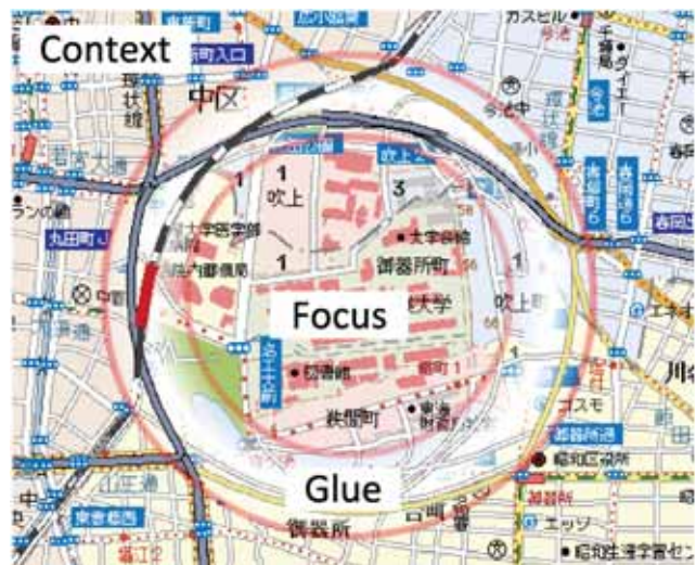
Figura 1 - Esempio di una mappa visualizzata con il metodo Focus+Glue+Context.
