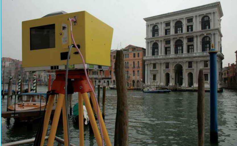
Figura 1 - Venezia: rilievo delle parti emerse con laser scanner (Optech ILRIS 3D)
