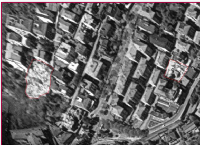
Figura 2 - Immagine EROS B (Risoluzione 0,7 metri): dettagli di crolli nell'area de L'Aquila.
