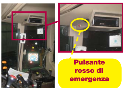
Fig. 4 : L'intero apparato è stato occultato anche per evitarne il danneggiamento. In posizione facilmente accessibile è stato invece installato il pulsante di emergenza per la richiesta di intervento alla centrale operativa di sorveglianza.
