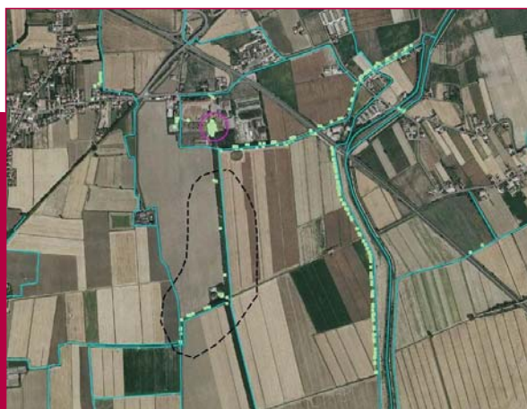
Fig. 6 : Posizioni assunte da un mezzo operativo durante l'attività lavorativa. Si distinguono tre situazioni tipo: stazionamento a riposo, solo trasferimento e fase lavorativa vera e propria.
