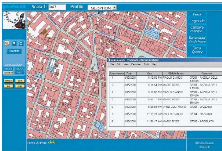
Figura 3 - L'operatore ha la possibilità di visualizzare sia i dati anagrafici del chiamante, sia le caratteristiche tecniche degli elementi delle reti.
