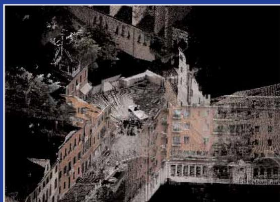
Figura 2: Scansioni laser terrestri, vista zenitale e vista assometrica di dettaglio
