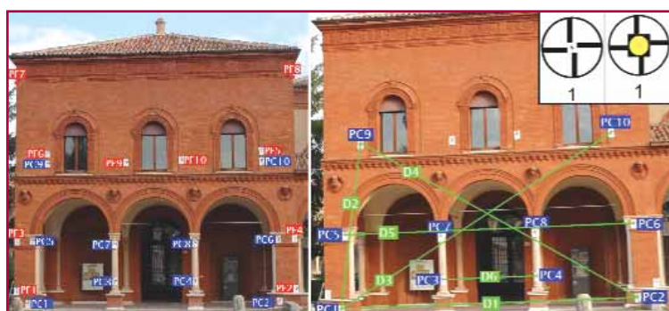
Fig.6 – Le riprese fotogrammetriche. A sinistra i punti d'appoggio fotografici (PF) e i punti di controllo (PC). A destra i segmenti di controllo (D). In alto a destra particolari del target cartaceo e di quello riflettente
