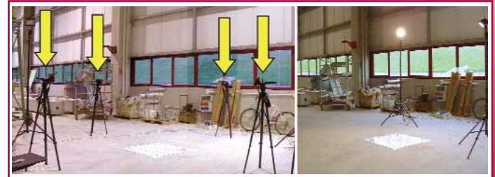
Fig. 3 - La ripresa della griglia di calibrazione.
