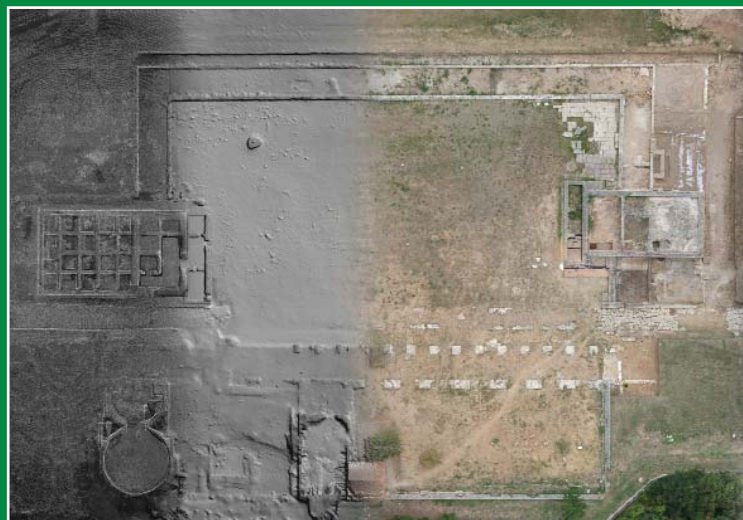
Figura 2 Rilievo del sito archeologico di Grumentum (Potenza): nuvola di punti ottenuti da laser scanner terrestre, DSM, ortofoto del foro.
