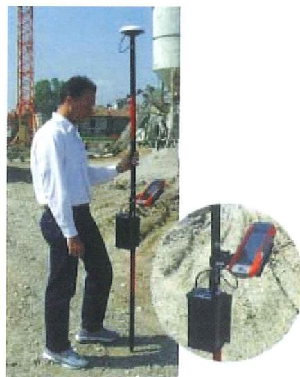
Con i nuovi sistemi **StarFire**<sup>®</sup>, che, grazie al software Gipsy in tempo reale, operano da soli senza stazione di riferimento e senza radio o GSM con precisione centimetrica, il topografo è libero di muoversi tra i punti da rilevare con il proprio ricevitore StarFire senza preoccuparsi di abbandonare un ricevitore fisso e senza temere la mancata copertura radio o gsm.
