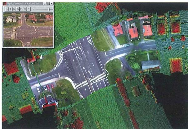
Fig. 5 - L'integrazione dei dati laser con le riprese fotografiche
