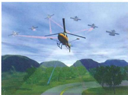
Fig. 3 - Schema delle riprese realizzate con il FLI-MAP
