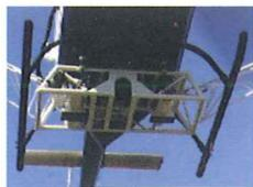
Fig. 4 - La struttura modulare con i sensori di ripresa installati sotto l'elicottero
