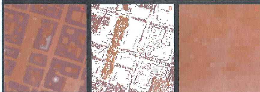
FIGURA 4 PARTICOLARE SU STRADA AMPIA: DSM LIDAR (A), DSM fotogrammetrico (B), DTM LIDAR (C), differenze tra DSM LIDAR e DSM fotogrammetrico(D), differenze tra DTM LIDAR e DSM fotogrammetrico «mascherato» (E)
