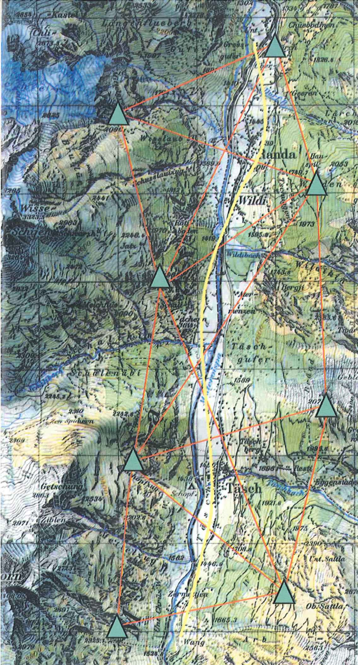
FIGURA 1 Il tracciato e la rete geodetica
