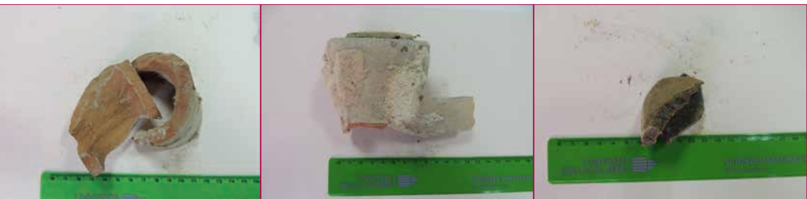
Fig. 6 - Il materiale campionato: ceramica rossa (a); malta di allettamento (b); ceramica con "cuore nero" (c)
