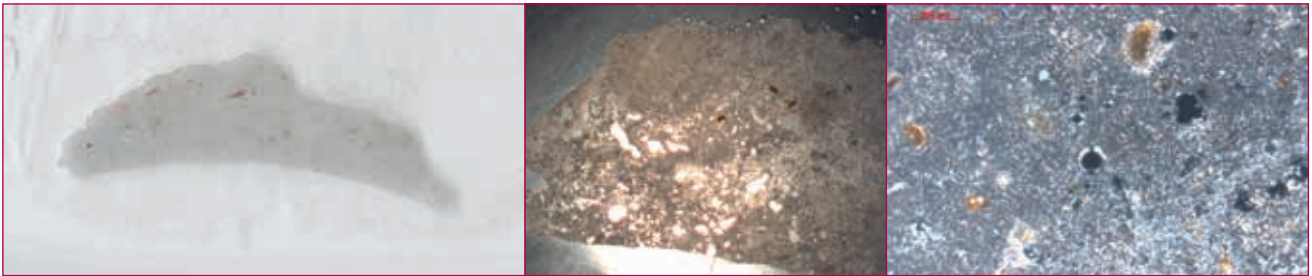
Fig. 9 - Campione 2L: Sezione sottile (a), immagine al microscopio ottico a luce naturale (b) e a luce polarizzata (c).
