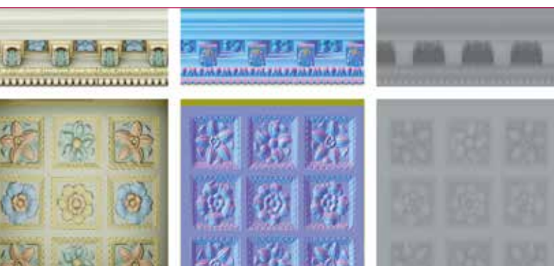
Fig. 13 - Parallax normal mapping: a) base map; b) normal map; c) height map.
