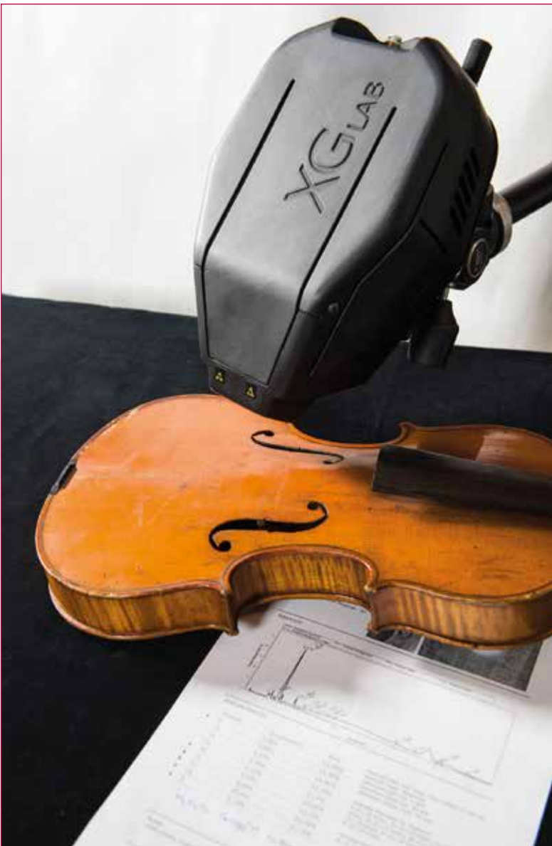
Fig. 6 - Lo spettrometro portatile PXRF Elio presso il Laboratorio Arvedi di Diagnostica non Invasiva.
