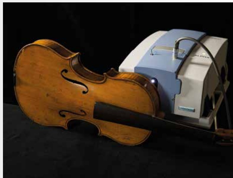
Fig. 7 - Lo spettrometro portatile FTIR Alpha-R presso il Laboratorio Arvedi di Diagnostica non Invasiva.
