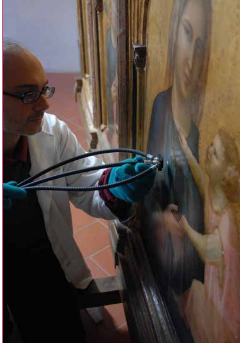
Fig. 2 - Misure FORS sul dipinto "Polittico di Badia" (c. 1300-01) di Giotto di Bondone, Galleria degli Uffizi, Firenze, per lo studio dei materiali pittorici durante l'intervento di restauro.
