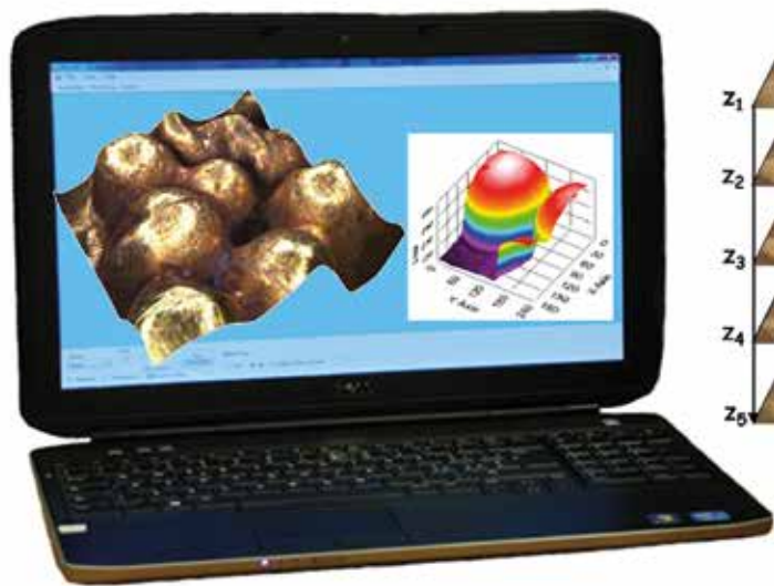
Fig. 4 - Microscopio 3D palmare a scansione di fuoco: esempio di rilievo di una granulazione su un gioiello antico.
