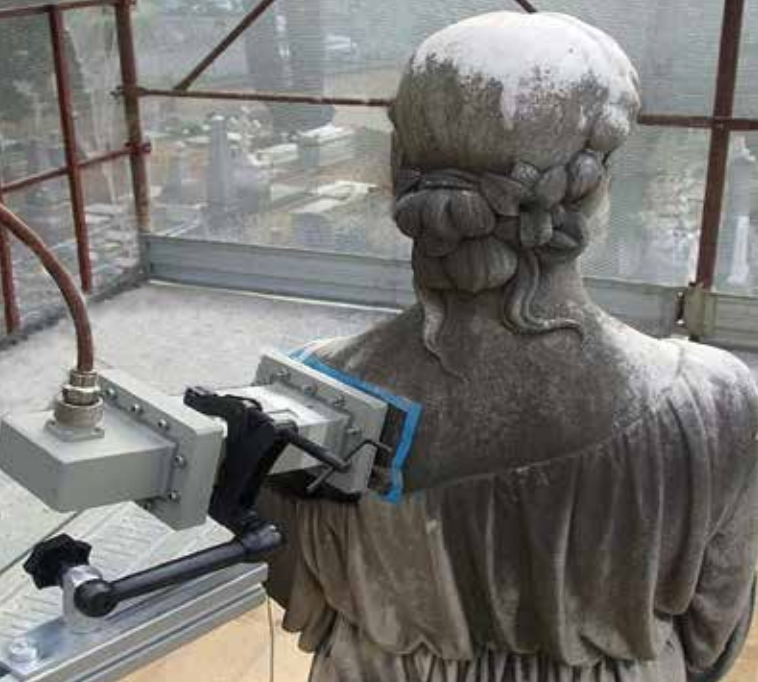
Fig. 8 - Sperimentazione del dispositivo biocida a microonde sulla Speranza di Odoardo Fantacchiotti.
