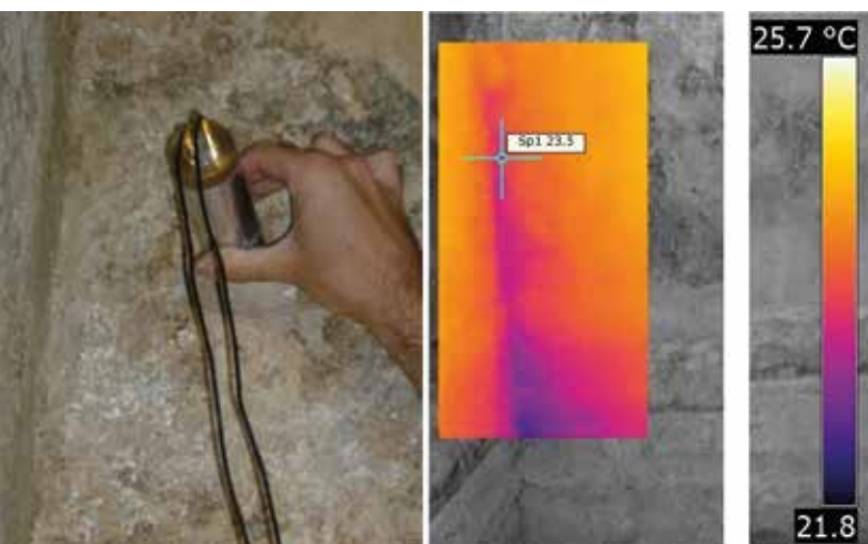
Fig. 5 - Uso dello strumento SUSI (a sinistra) per calibrare la misura termografica (a destra).
