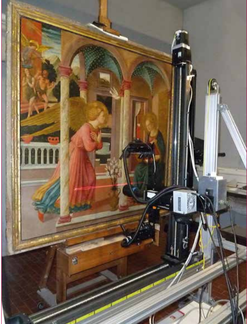
Fig. 1 - Scanner iperspettrale durante acquisizione misure sul dipinto “Annunciazione e Cacciata di Adamo ed Eva dal Paradiso Terrestre” (1450-1455) attribuito a Machiavelli Zano della Chiesa di San Martino a Mensola, Firenze, per lo studio della tecnica pittorica e dei materiali pittorici impiegati.
