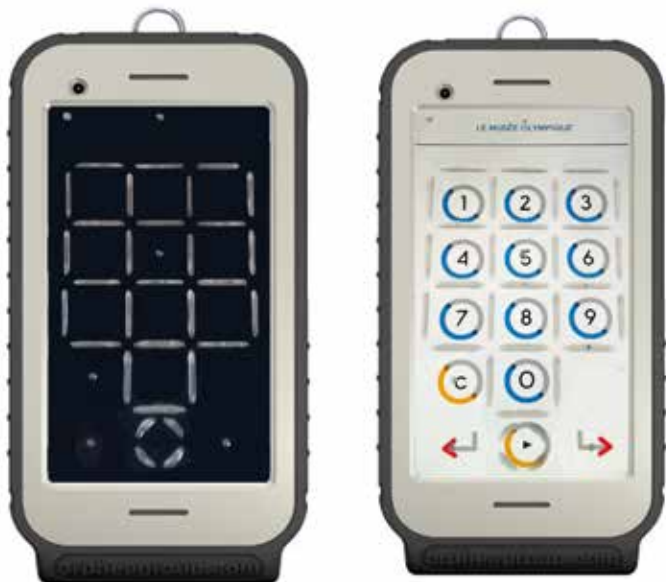
Fig. 5 - La tastiera in rilievo per i non vedenti
