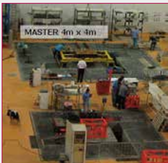
Fig. 1 - Le due tavole vibranti presso il Centro Ricerche ENEA Casaccia.
