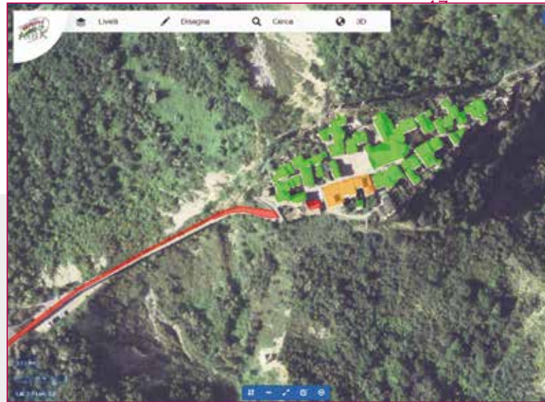
Fig. 2 - (pag. 18) Civita di Bagnoregio - classificazione della stabilità degli edifici ottenuta da analisi interferometriche da satellite. Elaborazione fatta a partire da dati COSMO-SkyMed.
